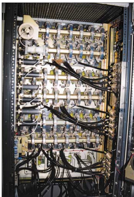
Rückansicht eines 19-Zoll-Gestells mit 48 Ringkern-Spulen zur Auskopplung
