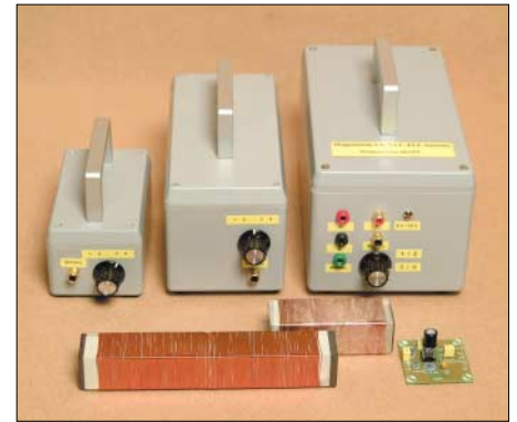
Bild 11: Die handlichen Kunststoffgehäuse beinhalten unterschiedliche Ferritantennentypen. Vorn sind die leistungsfähigen Kerne (für Industrieanwendungen) zu sehen. Daneben, rechts, UAP 5 als Antennenverstärker verschaltet [7]. Fotos: DG9WF
