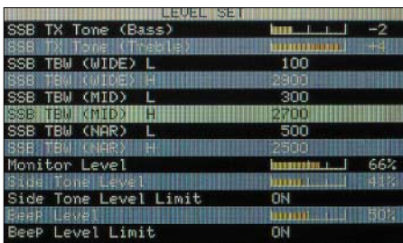
Bild 9: Im Level-Set-Menü lassen sich nun die Eckpunkte des Sender-Frequenzganges für die drei Bandbreitenstufen getrennt festlegen.
