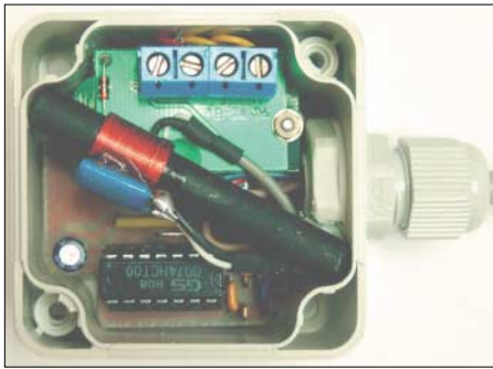
Bild 3: Blick in das geöffnete Plastikgehäuse mit dem DCF77-Empfänger Fotos: Bauer
