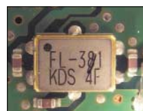
Bild 11: Als eher unscheinbares Bauteil erscheint das 64-MHz-Roofingfilter, das nun wie beim IC-7800 ein Grundwellentyp ist.
