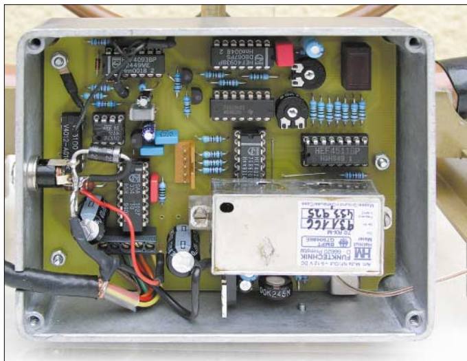
Bild 1: Funkempfangsmodul und Decodierung/Motoransteuerung sind in einem Metallgehäuse untergebracht. Die Antenne des Moduls ist isoliert nach außen zu führen.
