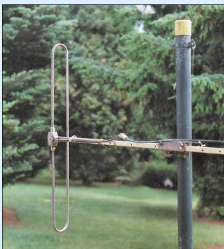
Bild 7: Vertikaldipol für FM-Betrieb auf 2 m; der Antennenträger der TV-Antenne dient gleichzeitig als Ausleger zur Befestigung am Mast.
