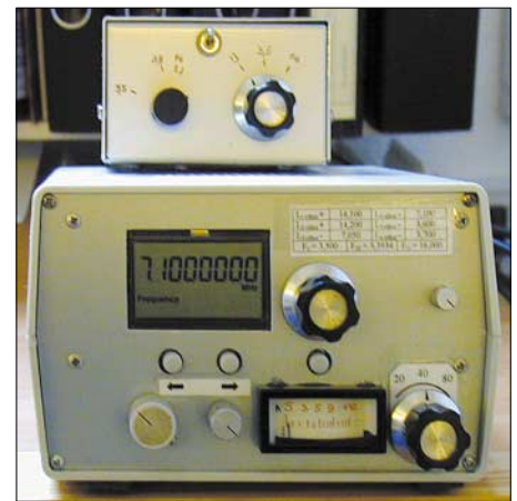
Bild 2: Empfänger mit eingebauter DDS; darüber der Preselektor
