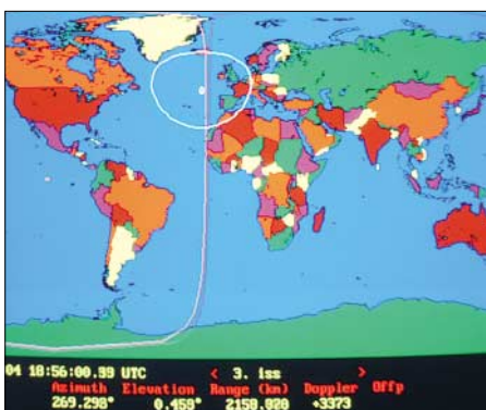
Bildschirmfoto des Antennennachführungsprogramms: Die weiße Linie kennzeichnet den Radiohorizont der ISS.
